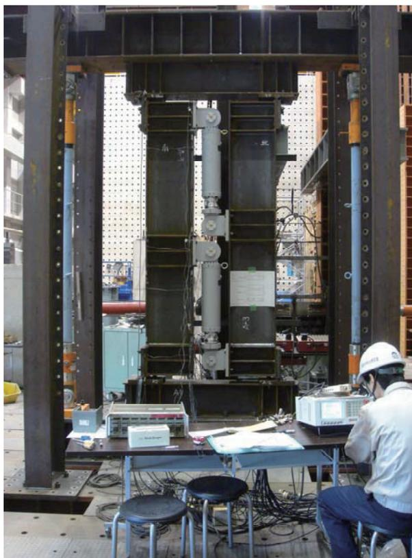
図 23 オイルダンパーを用いた制震装置の実験の様子と、実験で得られた力 - 変形関係[8]
